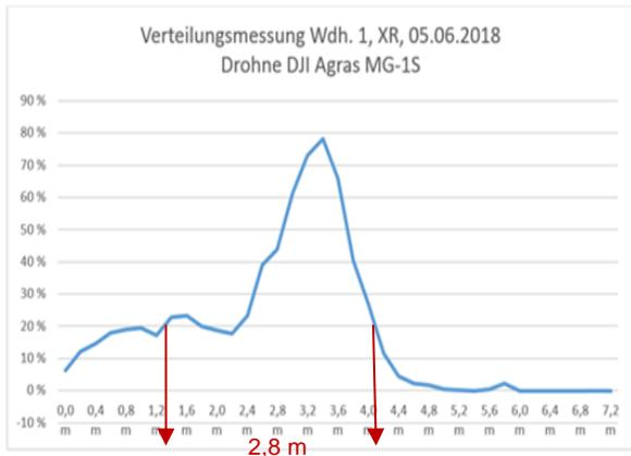
Abbildung 4 Verteilungsmessung Wdh. 1, 05.06.2018; XR110015; 75l/ha Ausbringungsmenge; 2,78m/s Fluggeschwindigkeit; 2,5l/min Düsenausstoß, Wind: 3,5m/s aus W
