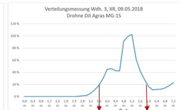
Abbildung 12 Verteilungsmessung Wdh. 3, 09.05.2018; XR110015; 75l/ha Ausbringungsmenge; 2,78m/s Fluggeschwindigkeit; 2,5l/min Düsenausstoß, Wind: 2,4m/s aus S
